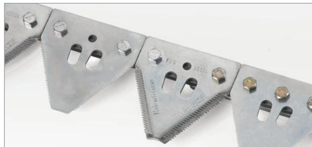
Kraftausgleich durch im Wechselschnitt angeordnete Messerklingen
