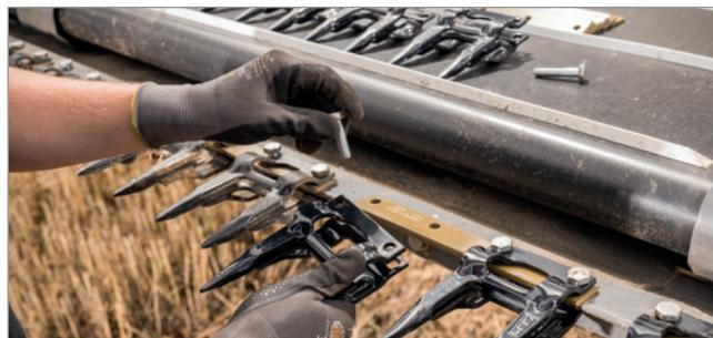
Schneller Ersatzteilaustausch durch komplett geschraubte Komponenten
