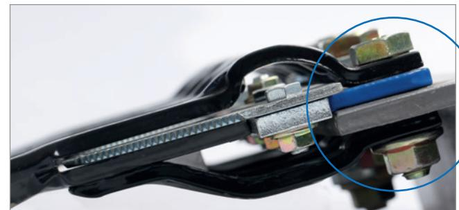
Beidseitig verschraubte Stahl-Mähfinger für eine hohe Stabilität
